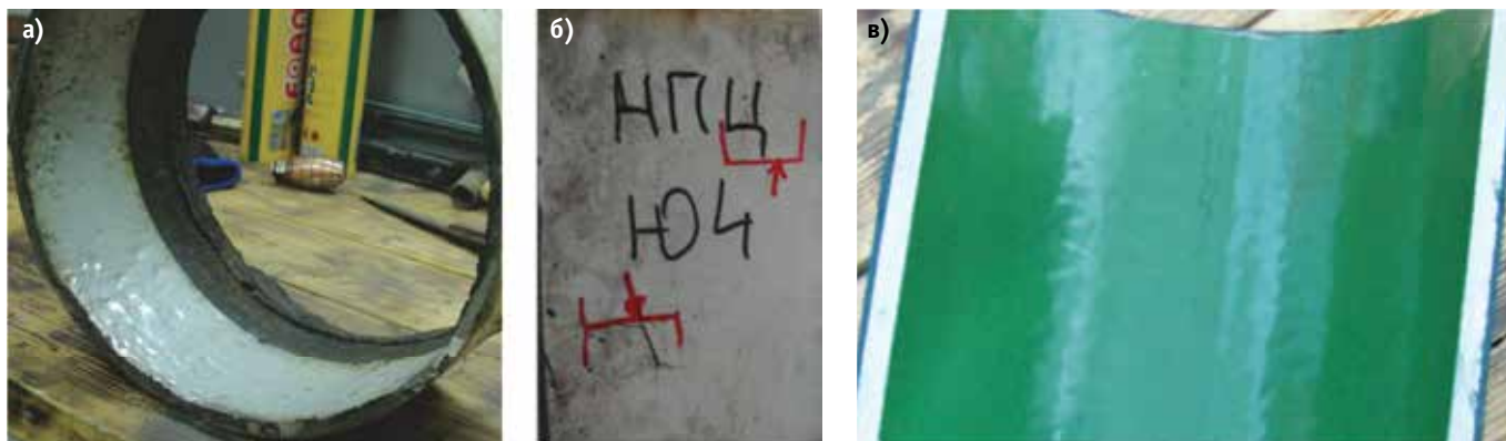
Фото 4. а, б) внешний вид исследуемого образца (стрелками указаны места изготовления шлифов), в) внешний вид покрытия, производимого ООО «ЮКОРТ»
