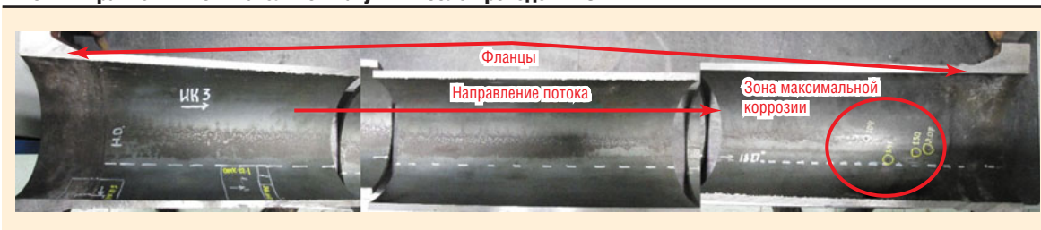
Рис. 1. Фрагменты испытательной катушки после проведения ОПИ
