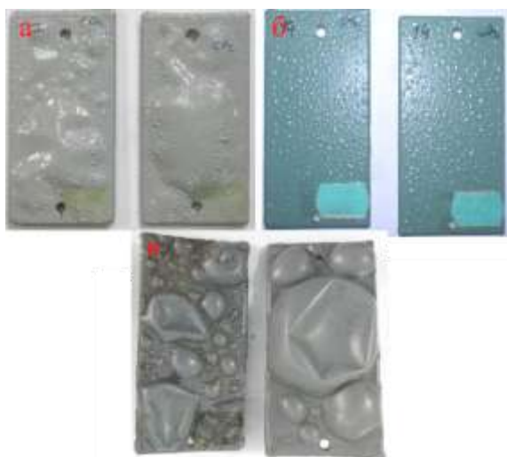
Рис. 1. Разрушения покрытия по декомпрессионному механизму а) ПЭП 7150, температура 110 °С; б) 3М Scotchkote 6258, температура 120 °С; в) INFRALIT EP 8074-00, температура 100 °С
