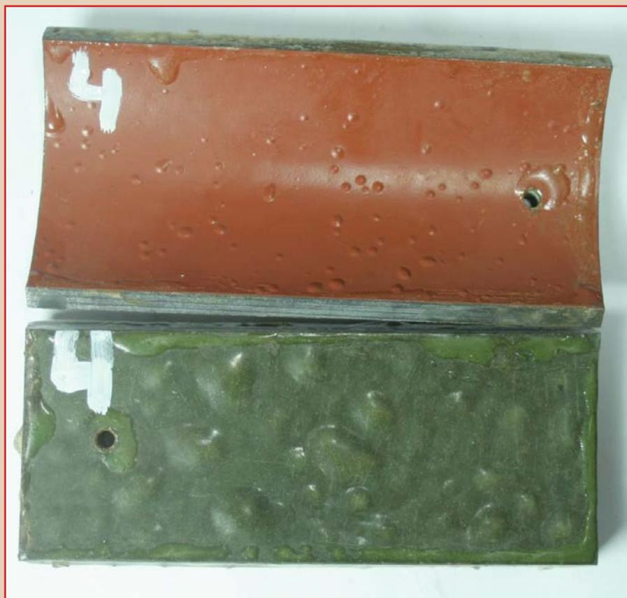
**Рис. 5.** Внешний вид покрытий после выдержки в автоклаве при температуре 80 °С, давлении 30 атм., 24 часа в CO<sub>2</sub>-насыщенной среде
