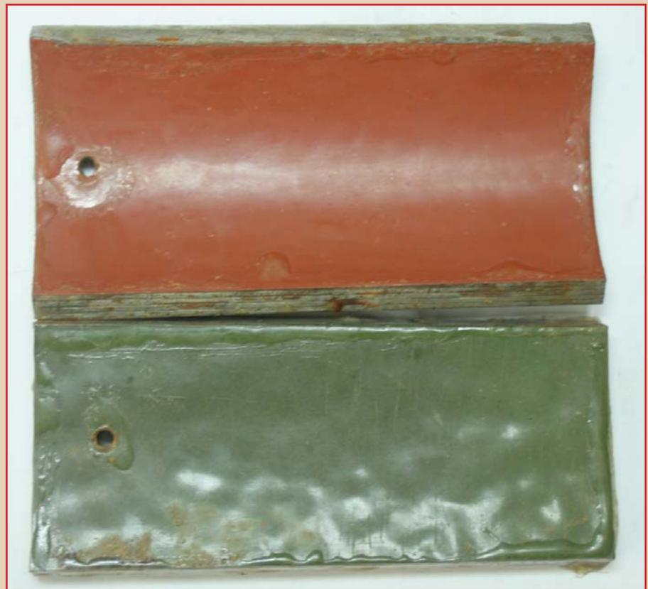
**Рис. 6.** Внешний вид покрытий после выдержки в автоклаве при температуре 80 °С, давлении 100 атм., 48 часов в N<sub>2</sub>-насыщенной среде
